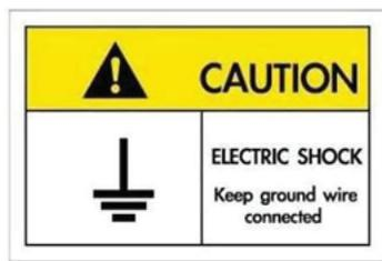
Para evitar choque elétrico, a unidade e seus periféricos devem ser adequadamente aterrados (aterramento).
