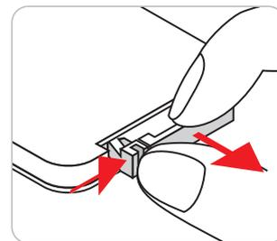
2. Instale a nova bateria no compartimento. Remova a bateria antiga e instale uma nova (CR2025). Certifique-se de que o lado com um "+" está voltado para cima.
