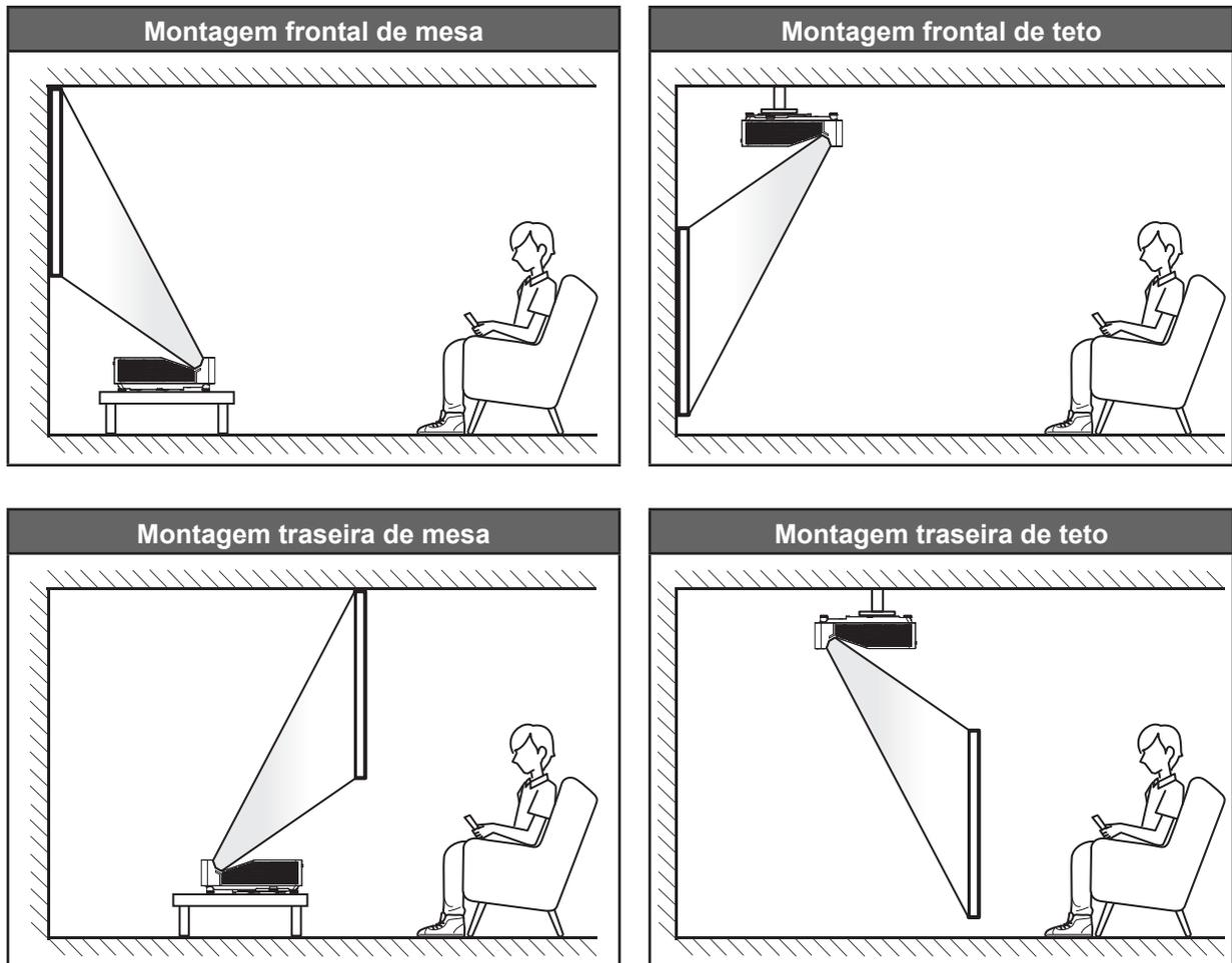
O projetor deve ser colocado em uma superfície plana e 90 graus/perpendiculares à tela.
