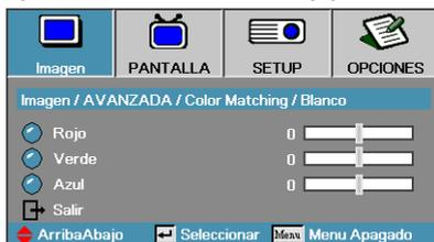
Presione ▲▼ para seleccionar Rojo, Verde o Azul y presione ◀▶ para ajustar las configuraciones.
